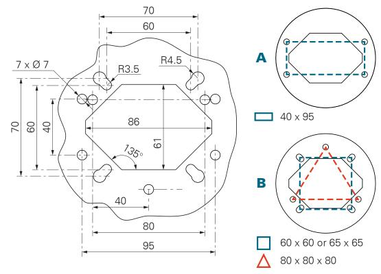
提供两种安装孔尺寸。在箱体顶端 可选择一个合适的安装孔。
